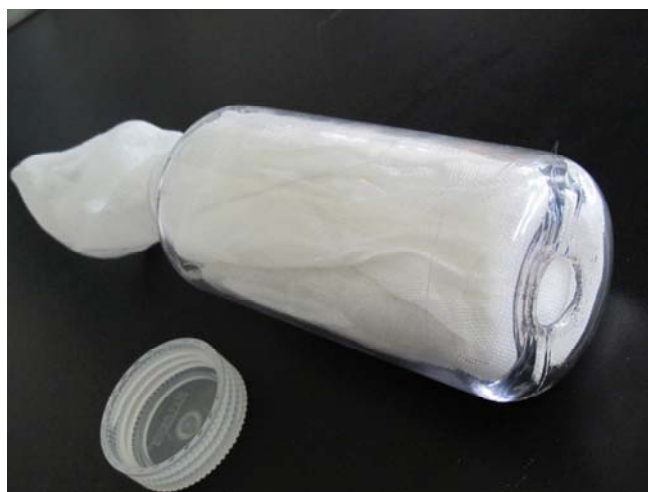
图 5. Moore 纱布，用于采集下水道水和污水。
