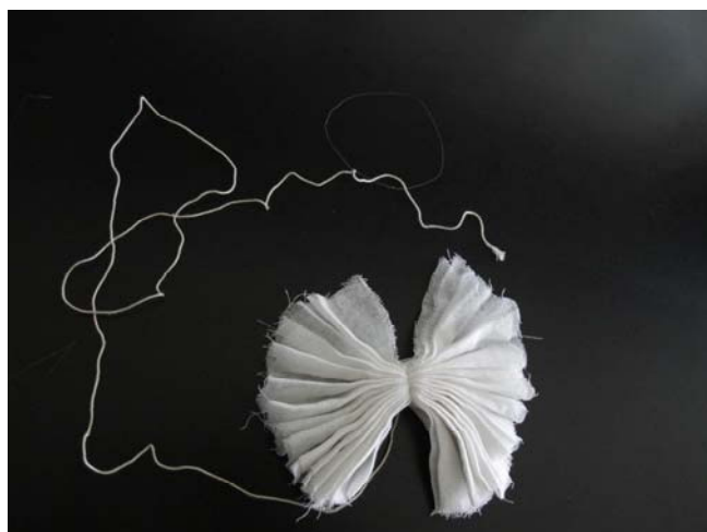
图 5. Moore 纱布，用于采集下水道水和污水。
